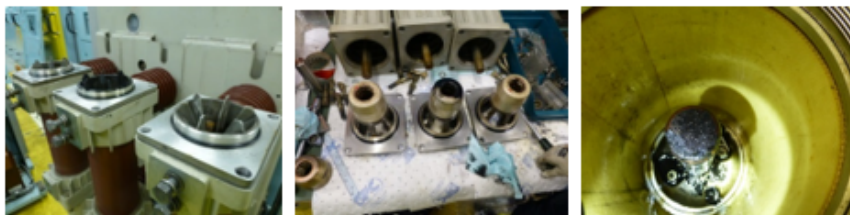
Fig: 7.1 Bryterkammer etter lysbue i fase L2
