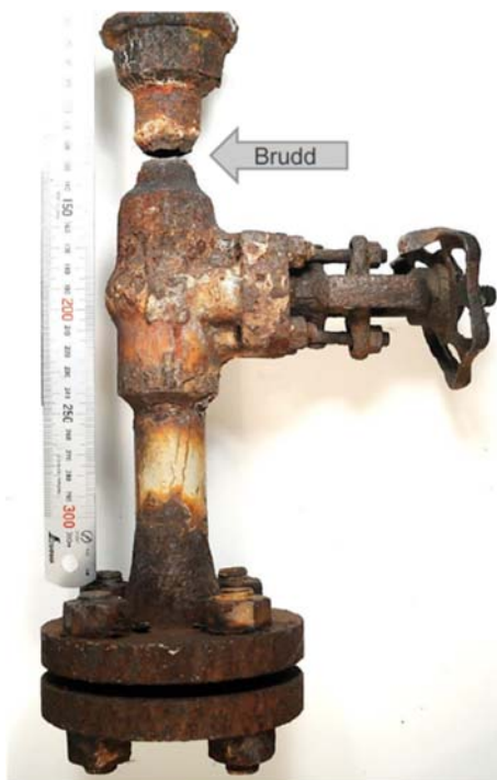
Figur 1.1.1 Ventil og avreven stuss
